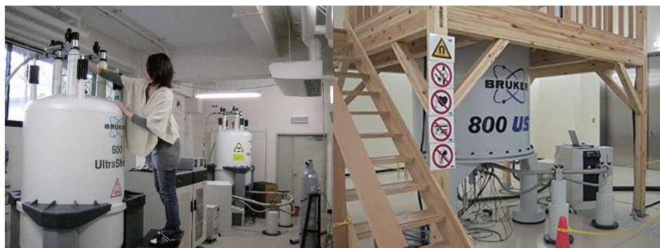
図3 NMR 装置群。(左) 2 台の 600 MHz, (右) 800 MHz.
