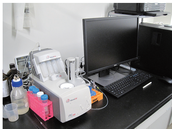
装置紹介3 等温滴定型カロリメトリー測定装置 分子の結合や解離によって発生する熱量の変化を測定して分子間相互作用を評価することができる装置。
