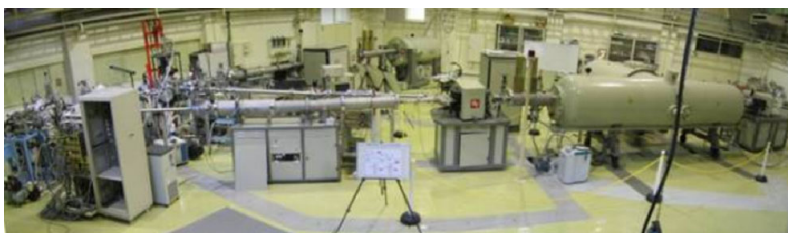
図 4.3.3 DuET 施設：2 基の MeV 級イオン加速器と精密照射ステージから成る
