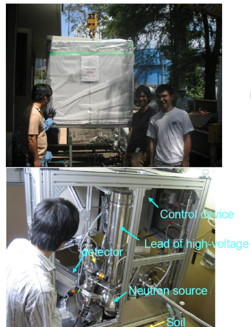
図 2.1.30 超小型慣性静電閉じ込め核融合中性子源を用いた地雷探知機
