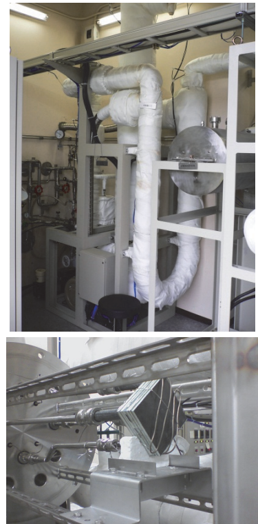
図2 LiPb-He 高温二重ループ（上）と、それにより実証された超高温複合材熱交換器（下）
