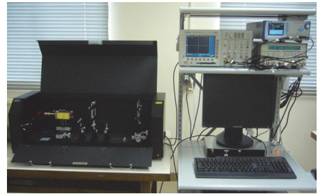
図1 Photo-CELIV 実験装置：光電子キャリアの経時的測定を実現
