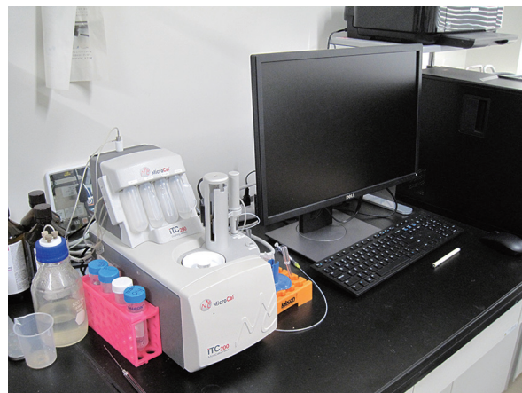
装置紹介 3 等温滴定型カロリーメトリー測定装置 分子の結合や解離によって発生する熱量の変化を測定して分子間相互作用を評価することができる装置。
