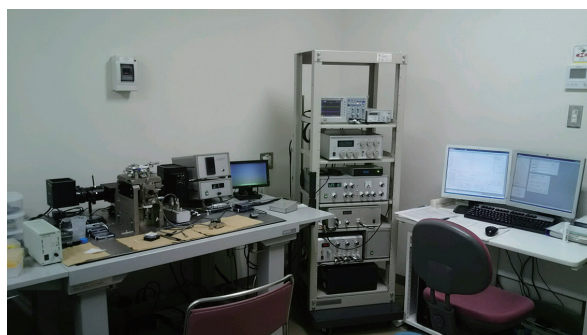
装置紹介 1 高速原子間力顕微鏡 カンチレバーを走査して、サンプルの高さや輪郭などの形状情報を得ることができる装置。
