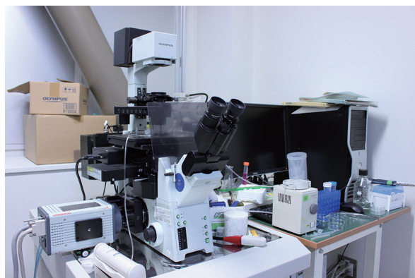
装置紹介 2 全反射照明蛍光顕微鏡 観察試料の表面近傍のみを局所的に励起することができる蛍光顕微鏡。
