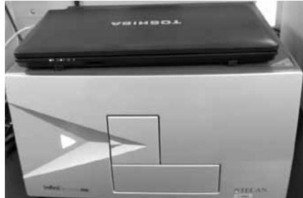
**Figure 5. Infinite 200 PRO (M200 NanoQuant)**
