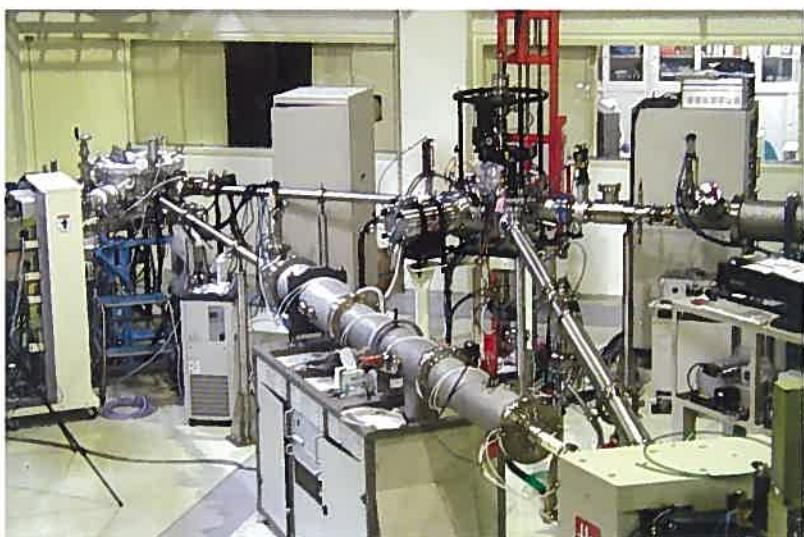
3. 2基のターゲットチャンバー(左: デュアルビーム材料照射ステーション、右: 超高温雰囲気制御材料分析ステーション) 手前の2本のビームラインはタンデム型加速器、奥のビームラインはシングルエンド型加速器からのイオンビームをそれぞれ輸送する
