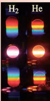
簡易な分光フィルムを通して肉眼で観測しても水素プラズマ (H<sub>2</sub>) とヘリウムプラズマ (He) とのスペクトルの違いがよくわかります。高感度・高分解能分光器により得られるプラズマの情報は膨大です。
