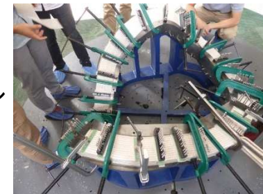
モックアップコイル製作状況
