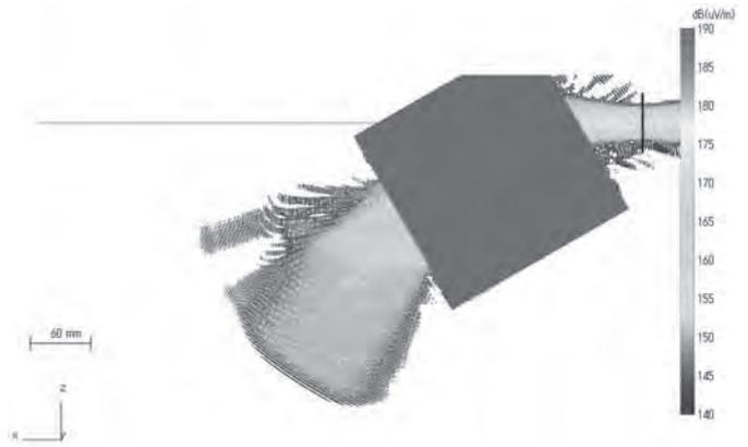
図 3 反射角度 30 度、導波管－ミラー間距離 150 mm、円筒状ミラー長 200 mm。右側のくびれた位置から左右両方向に伝播する様子。
