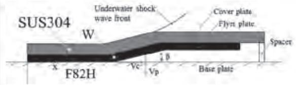
図1 水中爆接実験におけるセットアップの模式図
