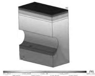
図 2 試験体の温度分布 (熱流束  $3.4\text{MW/m}^2$ )
