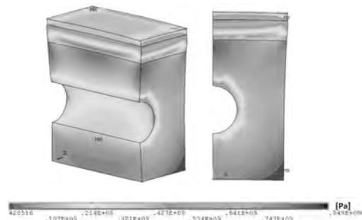
図 6 試験体の応力強さ分布 (熱流束  $3.4\text{MW/m}^2$ )
