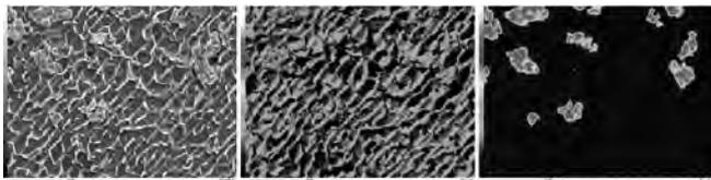
図 5 セシウム-テルル腐食試験後の SEM 像と Al, Te の元素マッピング図
