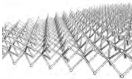
図1 遷移金属ジカルコゲニドの構造モデル図 (3原子厚の原子層物質である)
