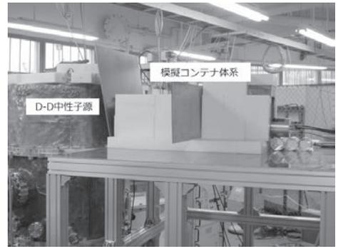
図 3 DD 中性子源と模擬コンテナ
