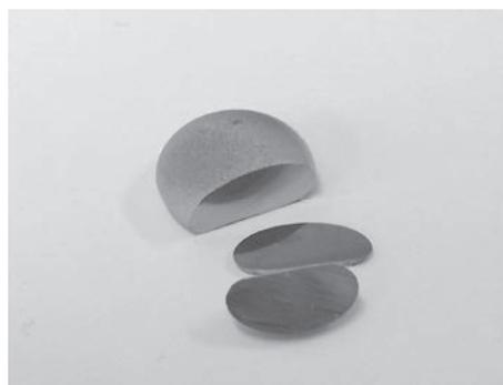
図3 アーク溶解で作製したSiの半数がFeに置換した組成 ( $\text{Ni}_{16}\text{Si}_{3.5}\text{Fe}_{3.5}\text{Mn}_6$ ) のG相単相インゴット。ハンマーで強打しても粉砕することは不可能であった。
