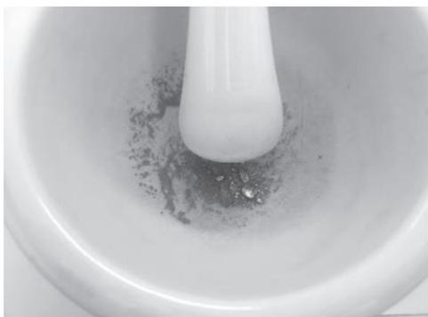
図2 アーク溶解で作製した化学量論組成 ( $\text{Ni}_{16}\text{Si}_7\text{Mn}_6$ ) のG相単相インゴット。磁性乳鉢で容易に粉砕できるほど脆い“脆性体”であった。
