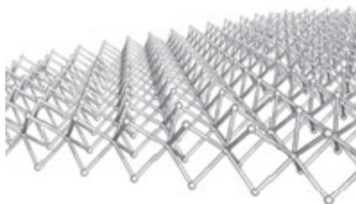
図 1 遷移金属ジカルコゲニドの構造モデル図 (3原子厚の原子層物質である)
