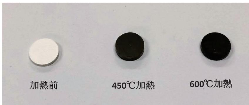
図3 加熱前（左）と450℃加熱（真ん中）と600℃加熱（右）の写真
