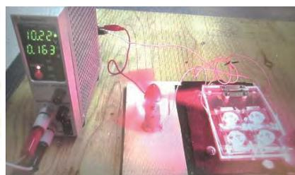
図5(左) 4枚並列のPVSK膜と4個直列の赤色LEDからなる試作PVSKダイスター。
