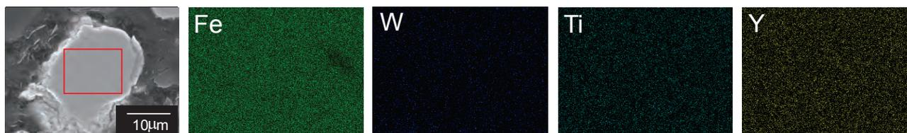
図2 メカニカルアロイングにより作製した MA 粉末断面の FE-SEM/EDS 分析結果
