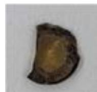
図3 LLZO ペレットに Li-rich ゼルを塗布・焼成したサンプル
