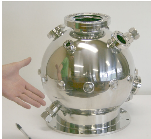
図 5.17.14 地雷探査用の水冷式超小型中性子源
