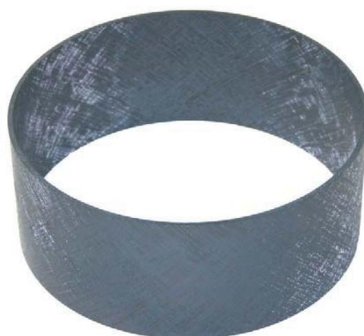
図1：本事業で開発したΦ200×80mmのNITE-SiC/SiC複合材料のチューブ
