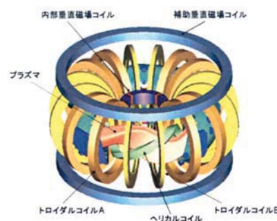
図1 ヘリオトロンJの外観図。トーラス半径1.2m。
