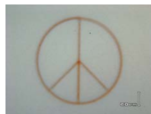
図2 多孔質シリコン上へ描画した銅のパターン
