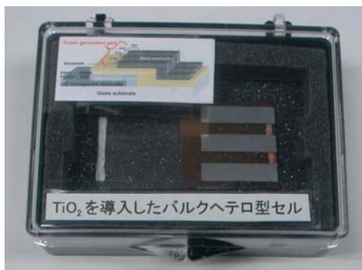
図3 デバイスの一例（有機薄膜太陽電池）
