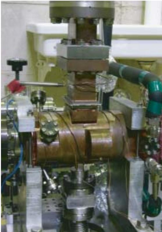
電子入射器としては、小型化と高輝度化を同時に図るために、4.5空胴の高周波電子銃を開発・試作しました。熱陰極を用いた簡単な高周波電子銃により、全長236 mmですが、約9 MeV、平均電流約1.6 Aまでの高輝度な電子ビームを発生できます。現在、更なる高輝度化のための研究が行われています。
