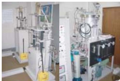
環境強度特性評価装置/SCC感受性評価装置
