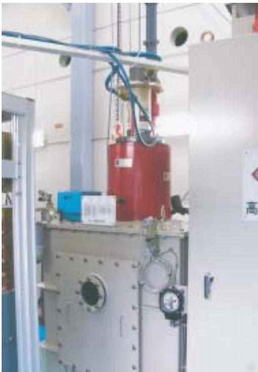
クライストロンは、高周波電子銃や加速管での、電子ビームの加速に必要な高周波電力を供給する装置です。KUFELでは、2台のクライストロン装置を用い、高周波電子銃のためにピーク出力10 MW、加速管のためのピーク出力20 MWまでの電力増幅を、最大パルス幅10 ms、最大繰り返し10Hzで行います。また、安定した自由電子レーザーを発生させるために、高安定度(<0.5 %)で高平坦度(<0.3 %)の高周波電力を発生できる、特殊な電源装置(モジュレータ)が導入されています。
