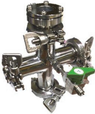
図3 製作したガス用セル。
