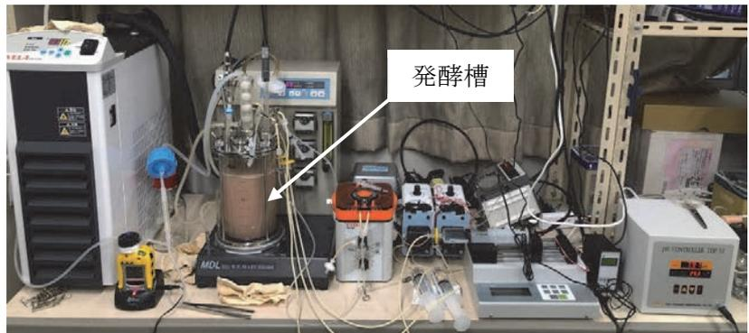
図3 培養装置の構成
